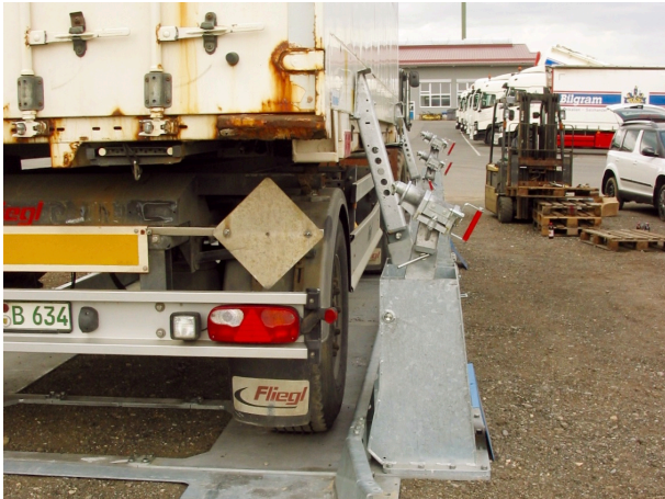
Befestigte Stützen an einer Wechselbrücke
