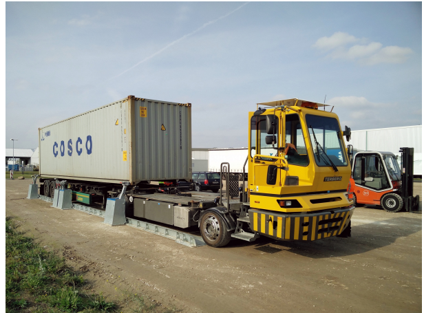
Double BoxStation für 20', 40' und Wechselbrücke
