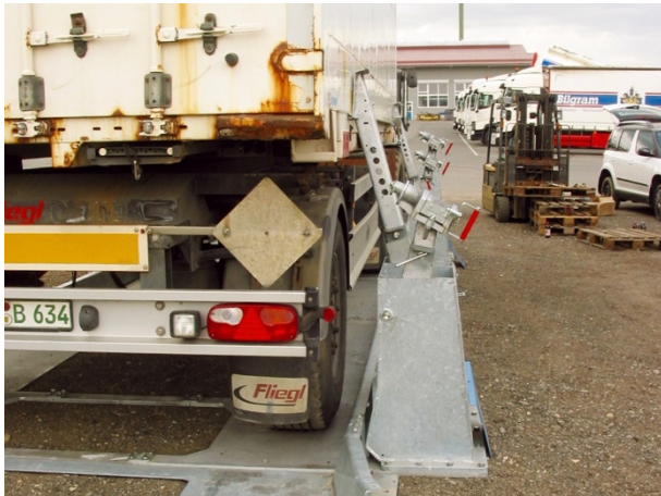
Befestigte Stützen an einer Wechselbrücke
